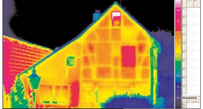
Abb. 9 Aufnahmen mit einer Thermografie-Kamera machen Wärmebrücken sichtbar (Quelle: Energieberatung Kremser)
